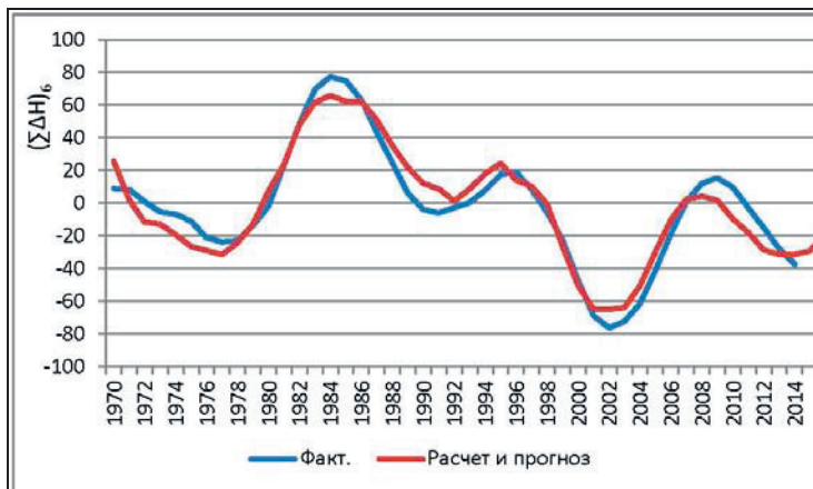
Рис. 7. Ход фактических и рассчитанных по уравнению накопленных по 6-летиям годовых приращений уровня с прогнозом до 2020 г.
