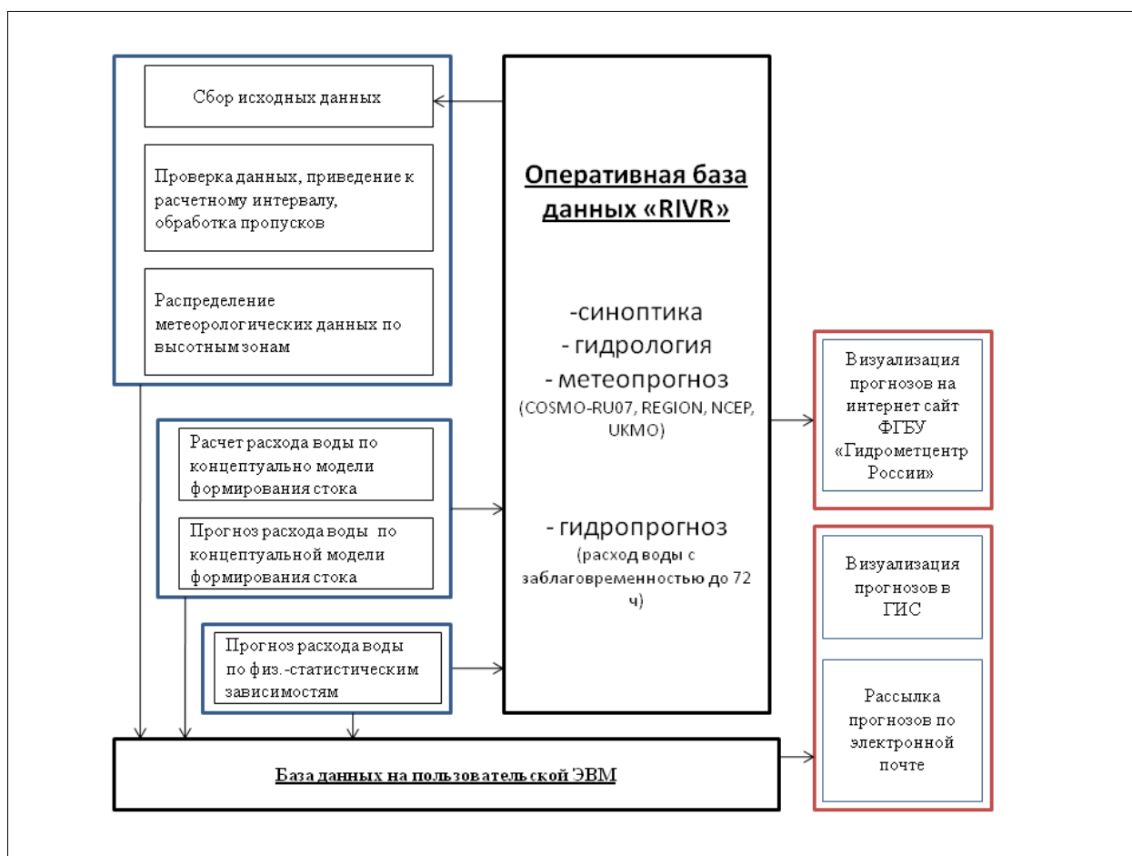
Рис. 3. Схема автоматизированной системы краткосрочных гидрологических прогнозов для рек бассейна Кубани.
