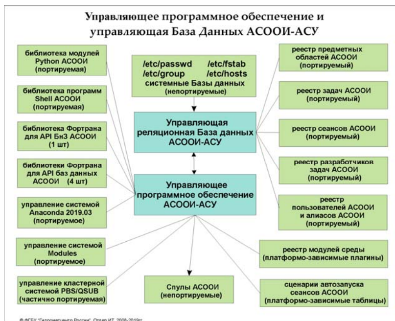
Рис. 4. Управляющее программное обеспечение и управляющая База данных технологии АСООИ.
