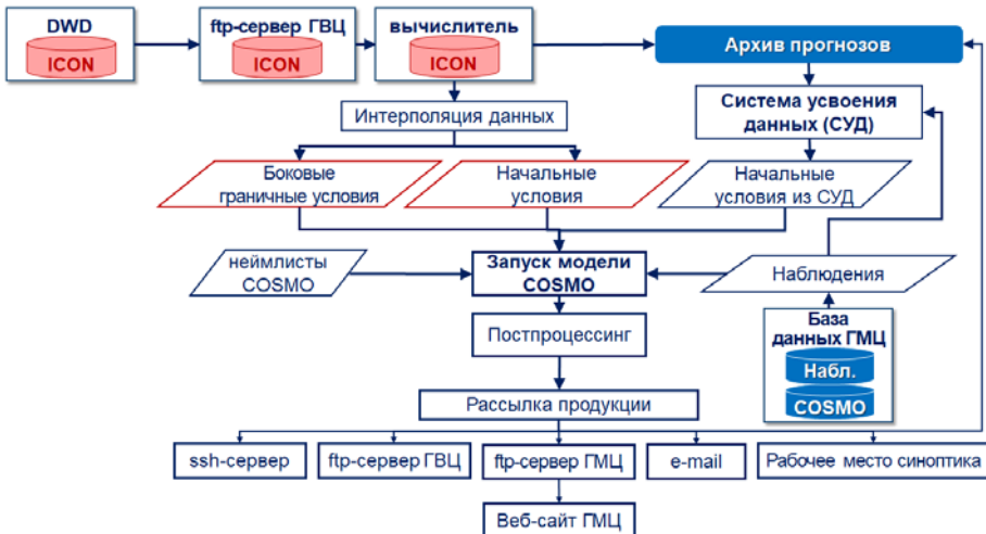
Рис. 2. Схема технологической линии системы ЧПП COSMO-Ru. Fig. 2. The technological line of COSMO-Ru NWP system.
