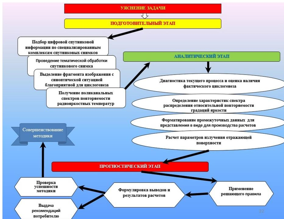
**Рис. 10.** Схема методики прогноза циклогенеза по спутниковыми данным.
