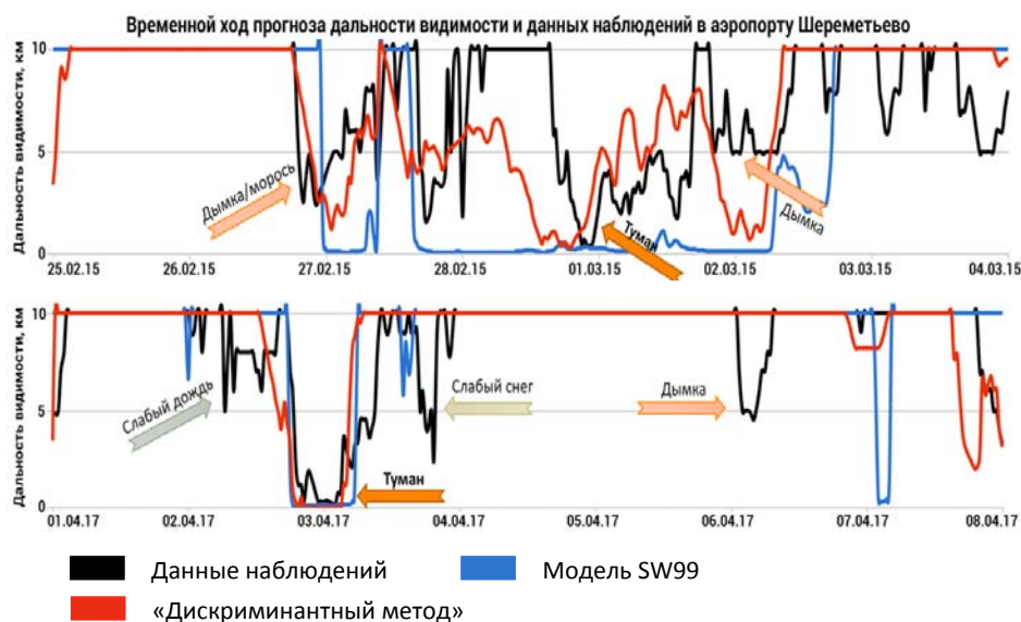
Рис. 4. Временной ход прогноза дальности видимости по модели SW99 и «дискриминантному методу» и данных наблюдений в аэропорту Шереметьево. Fig. 4. The time course of the visibility forecast according to the SW99 model and the discriminant method and in comparison with the observational data at Sheremetyevo Airport.
